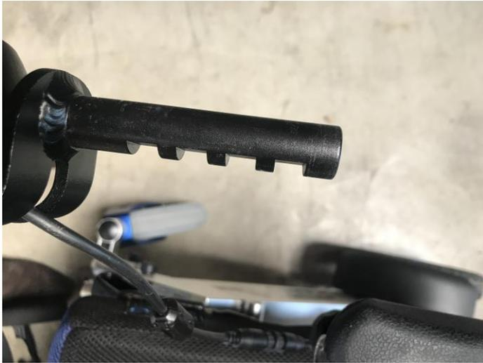
Le support du joystick dispose de 4 positions. Fixez le joystick et son support dans le tube droit ou gauche situé sous la manchette
