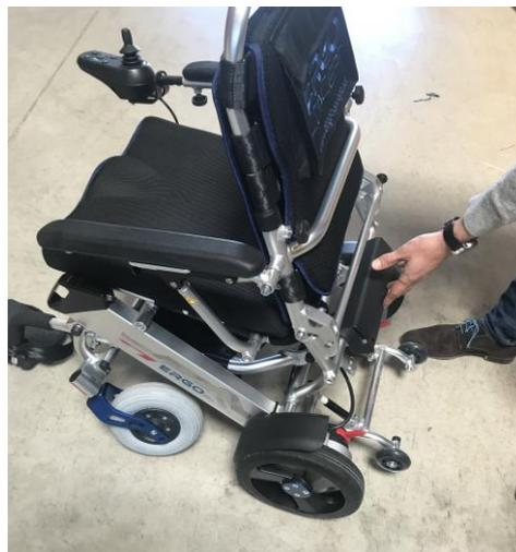
En tirant ce tube rouge vers l'arrière, vous libérerez le système de verrouillage, il faut, en maintenant ce tube vers l'arrière, pousser le dossier vers l'avant.
