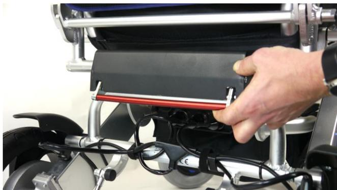
A l'arrière du fauteuil, identifiez le tube horizontal rouge de déverrouillage du pliage.
