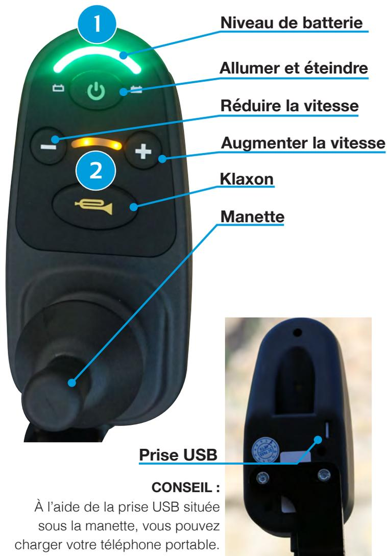
**1** **Niveau de batterie :** indique le niveau de charge. Lorsque les batteries sont pleines toutes les lumières sont allumées. Mettez en charge lorsque les deux tiers des lumières sont éteintes.
