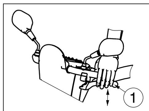
Le serrage du frein à main peut être ajusté avec le réglage du câble de frein.
