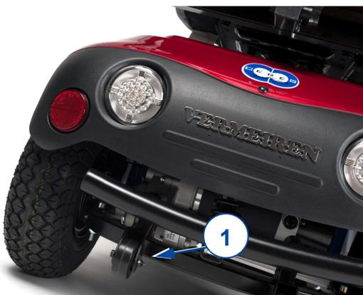
Un anti-basculement (1) est fixé à l'arrière du châssis du scooter. Il n'est pas possible de le retirer. L'anti-basculement est là pour votre sécurité. Il empêche le scooter de basculer vers l'arrière lorsque vous franchissez de petits obstacles qui ne dépassent PAS la hauteur maximale indiquée au §6.
