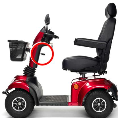
Le boîtier de direction peut être réglé dans de nombreuses positions (en continu) pour s'adapter à chaque conducteur.
