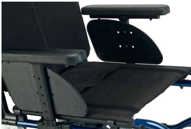
BRU020065 – Toile nylon, rembourrée, noire. Equipée de velcro pour maintenir le coussin en place. Réglable en tension pour éviter l'effet hamac, en retirant les bouchons des tubes d'assise et le rail.
