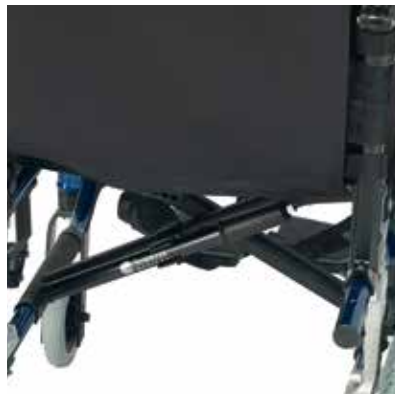
BRU090025 – Pompe Fixée sur le croisillon
